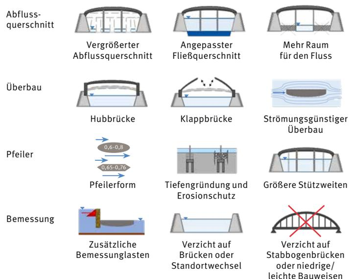
IDEEN FÜR HOCHWASSERANGEPASSTE BRÜCKENBAUWEISEN (GRAFIK: BURGHARDT ET.AL. 2022)
